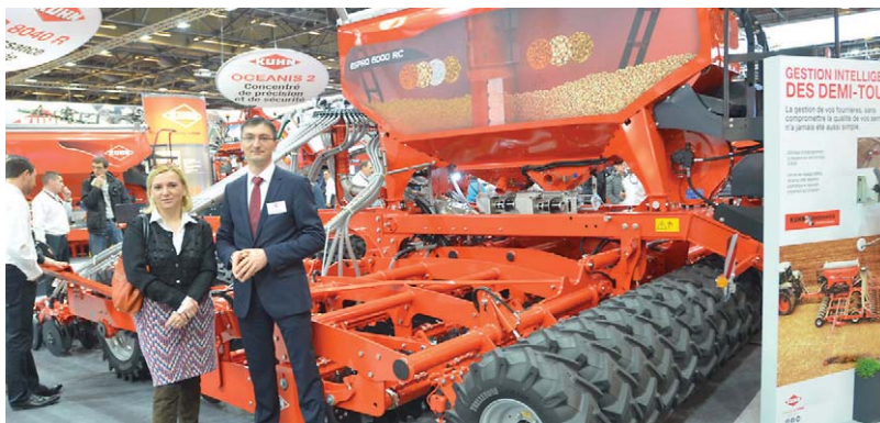
Inovacija Kuhna je sijačica čiji je spremnik moguće podijeliti na dva dijela i tako implementirati u tlo i sjeme i gnojivo
