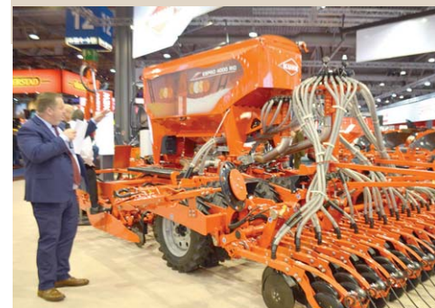
ESPRO 4000 RC s dvostrukom distribucijom (sjemena i gnojiva)
